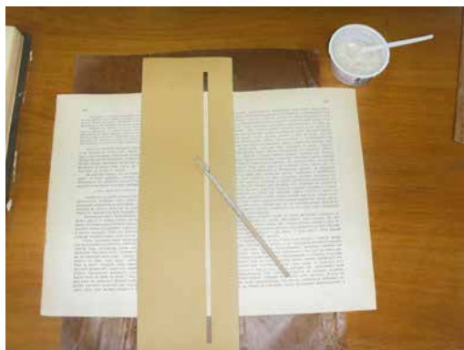
Рис. 7. Применение трафарета для подклейки двойного листа.
