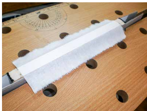
Рис. 22 Укрепление корешка блока в тисках.
